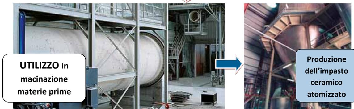
Raggiunto il carico ottimale per il trasporto il residuo produttivo viene avviato al processo di macinazione ad umido per la **formulazione di impasto atomizzato per l'industria ceramica.**
