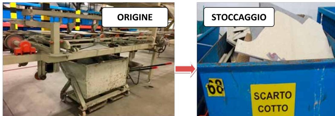
Lo 'scarto ceramico cotto formato' viene raccolto a lato della linea di produzione e giornalmente trasferito all'interno di container scarrabili posizionati all'interno del perimetro produttivo.
