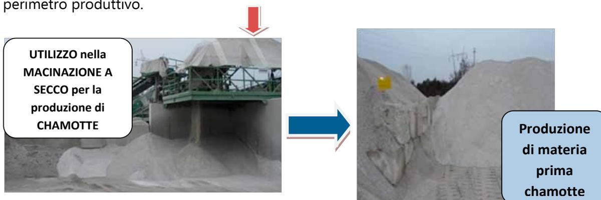
Raggiunto il carico ottimale per il trasporto il residuo produttivo viene avviato al processo di macinazione a secco finalizzato alla **produzione di materia prima (CHAMOTTE)** per l'industria ceramica.
