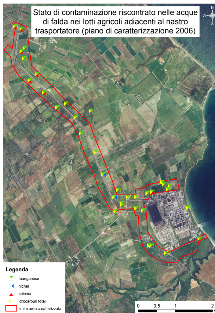
Stato di contaminazione riscontrato nelle acque di falda nei lotti agricoli adiacenti al nastro trasportatore (piano di caratterizzazione 2006)
