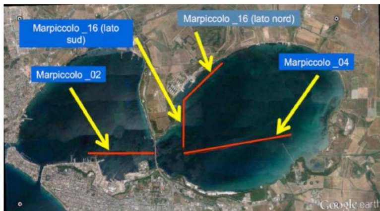
Principali percorsi rilievi sparker (rilievi sismografici)
