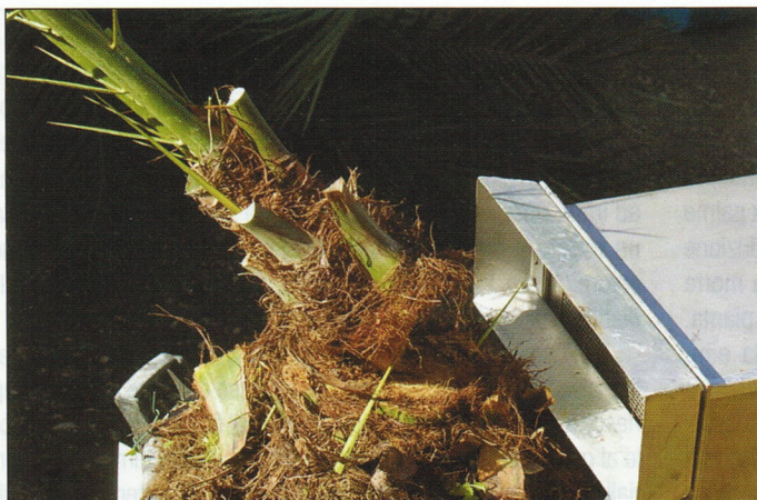
[ 2. Le temperature esterne. Applicatore a microonde e palma esposta (a sx) e termogramma della superficie esterna della palma dopo 30 min di trattamento a microonde (a dx).
