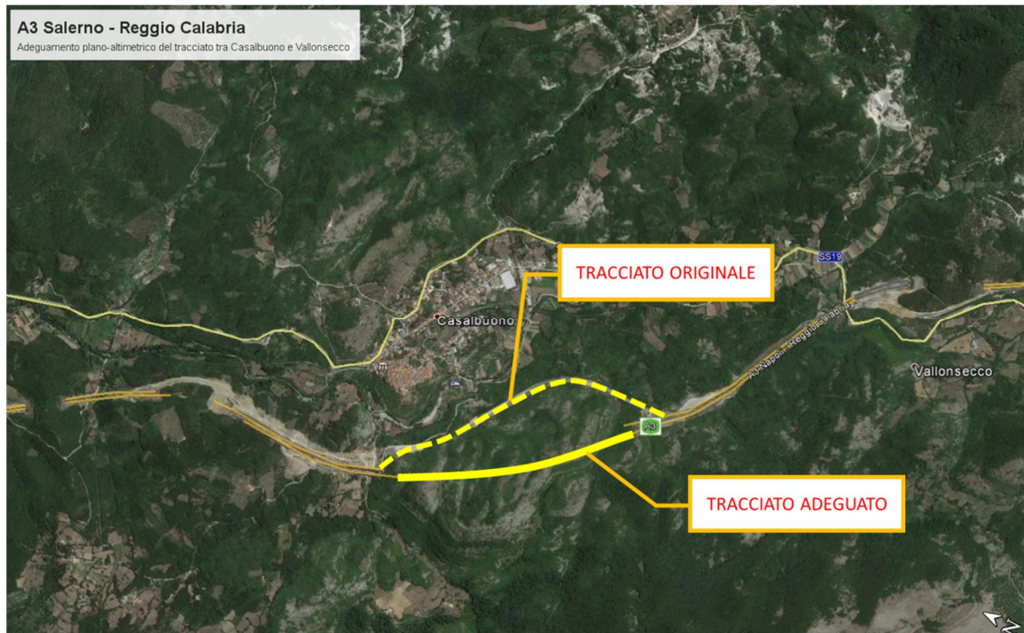
Figura 29: Autostrada A3- Adeguamento plano-altimetrico tra Casalbuono e Vallonsecco
