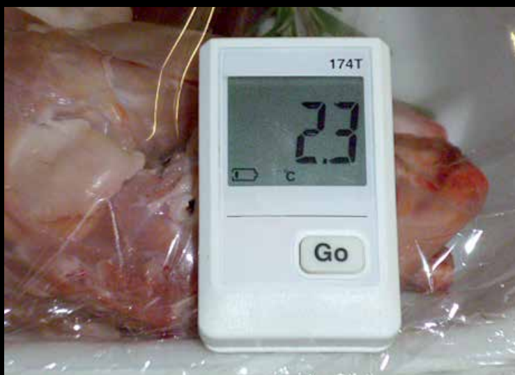
34. Strumento per la misurazione in continuo della temperatura
