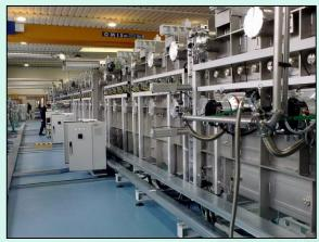
Impianto industriale di sputtering per la fabbricazione del coating solare ENEA presso il sito produttivo di Massa Martana (PG)
