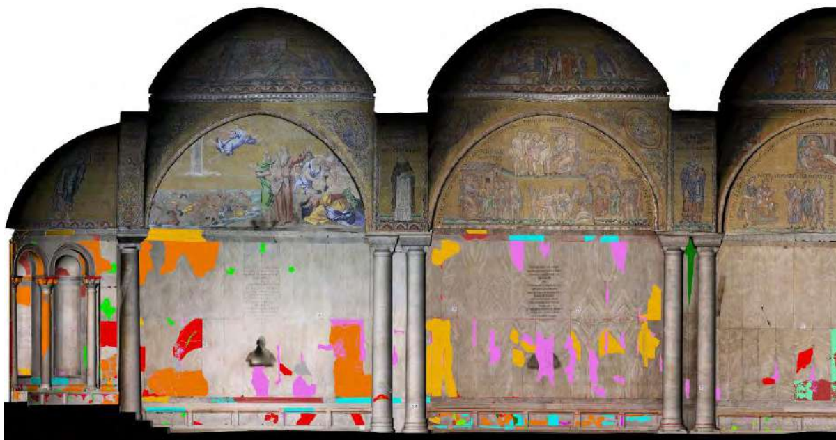
Figura 9 – Mappatura delle forme di degrado relative alla parete verso chiesa del nartheco settentrionale.
