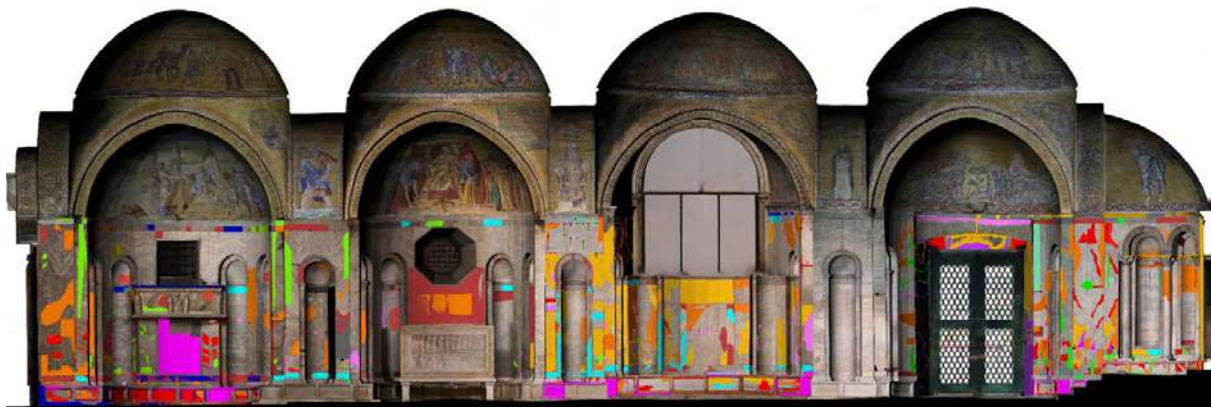
Figura 8 – Mappatura delle forme di degrado relative alla controparete settentrionale del narcece.
