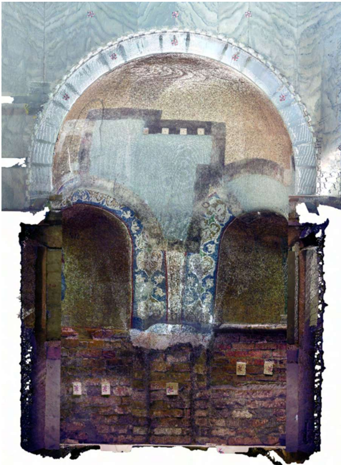
Figura 3 – Rilievo laser-scanner dell'interno della tomba; nuvola di punti rilevati.
